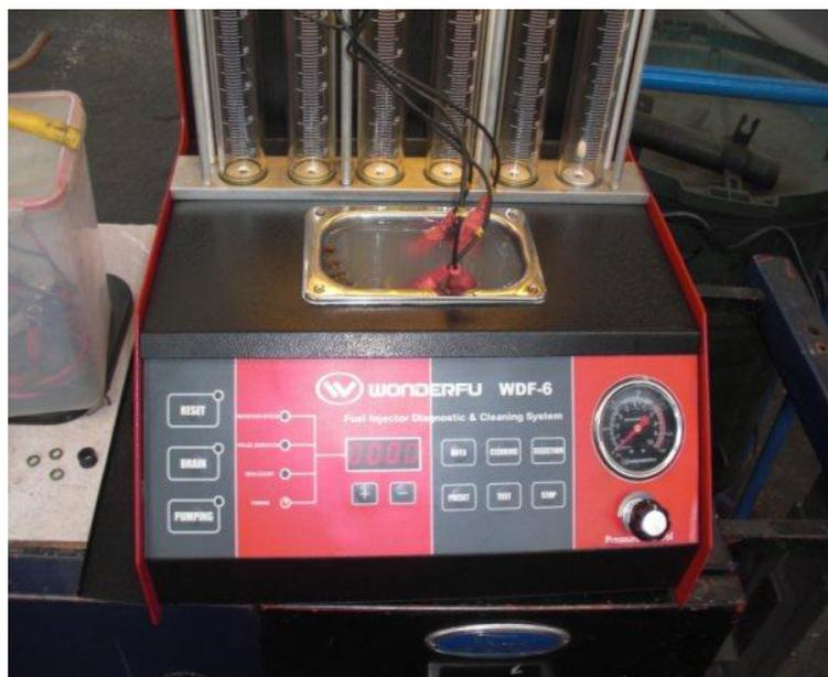
Fig. 52. Limpieza de Inyectores
