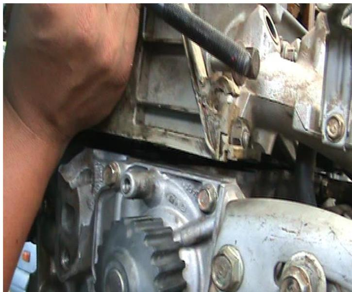
Fig. 47. Colocación de cabezote
