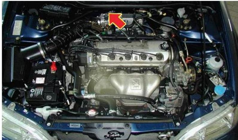
Fig. 11. Localización del Sensor MAP en el vehículo<sup>11</sup>
