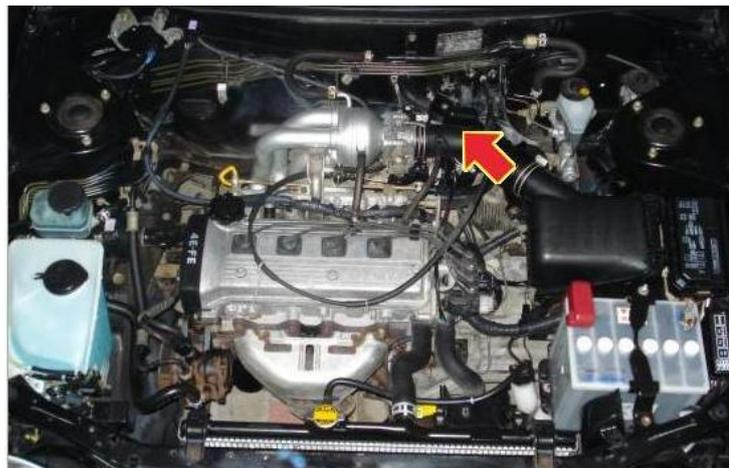
Fig. 17. Localización del Sensor de Temperatura del Aire en el vehículo<sup>17</sup>
