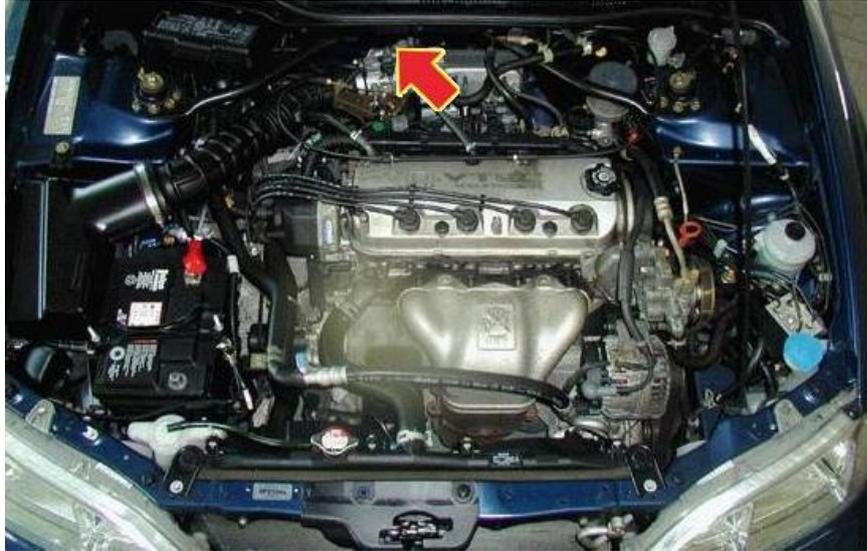
Fig. 19. Localización del sensor (TPS) en el vehículo<sup>19</sup>
