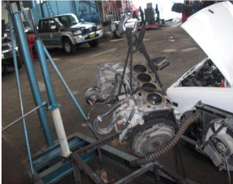
Fig. 37. Desmontaje motor de su base
