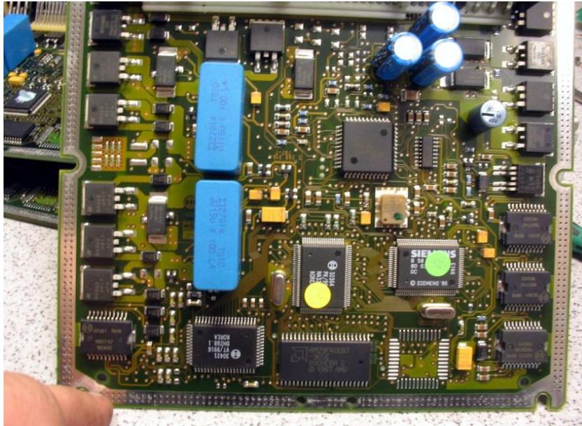
Fig.3. Computador del Vehículo<sup>3</sup>
