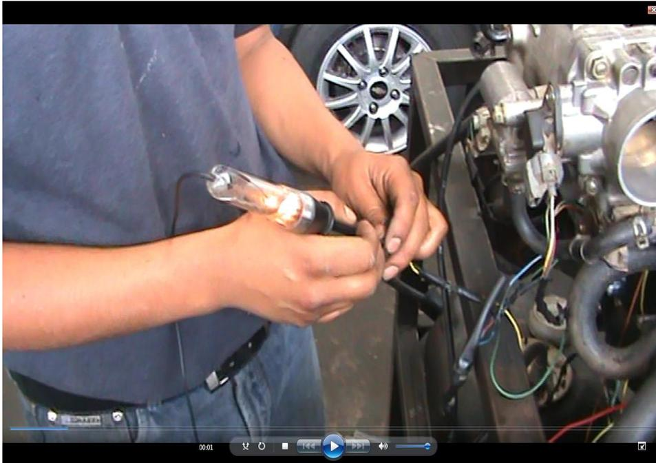
Fig. 66 Revisión continuidad de salida ECM
