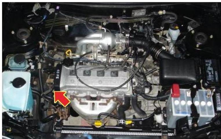
Fig. 22. Localización del sensor CKP en el vehículo<sup>22</sup>
