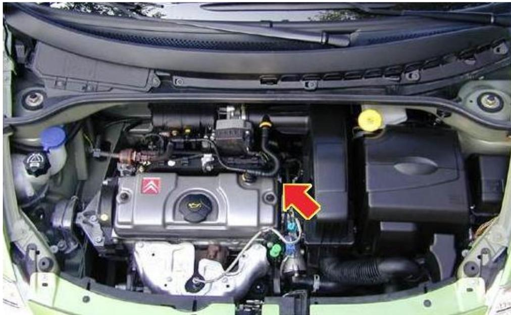
Fig. 13. Localización del sensor de RPM en el vehículo<sup>13</sup>
