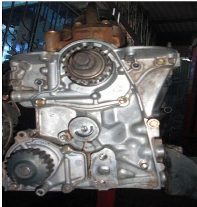
Fig. 33 Desmontaje total de Distribución
