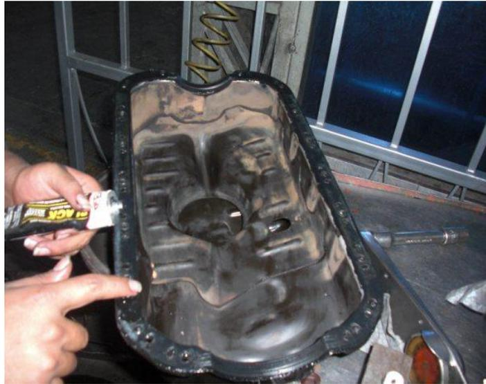
Fig. 45 Colocación de silicón
