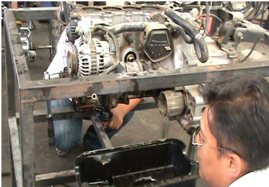
Fig. 36. Desmontaje de cárter
