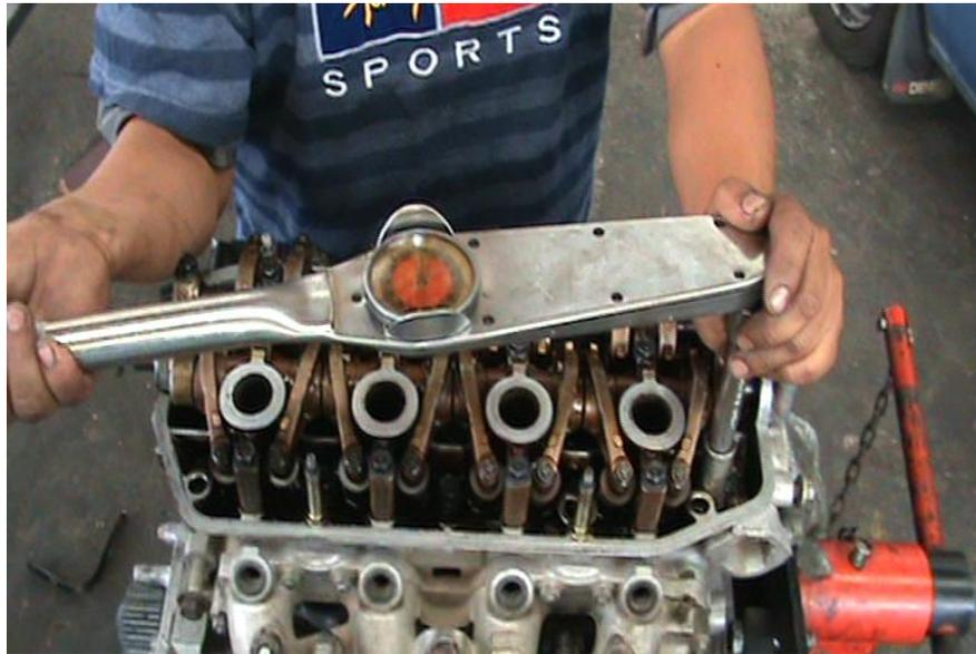
Fig. 49 Ajuste de pernos cabezote
