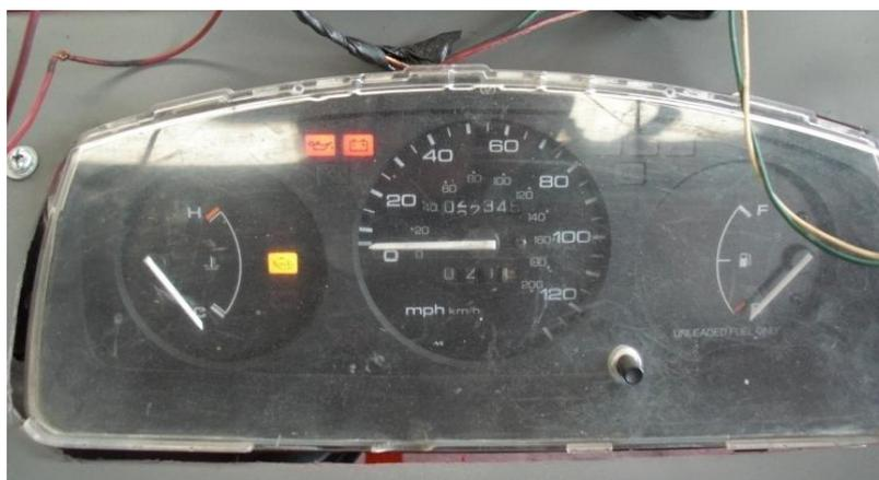
Fig.85. Iluminación luz check engine
