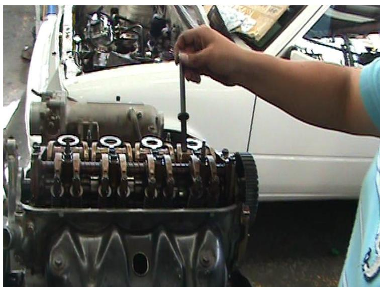
Fig. 48. Colocación de pernos de cabezote
