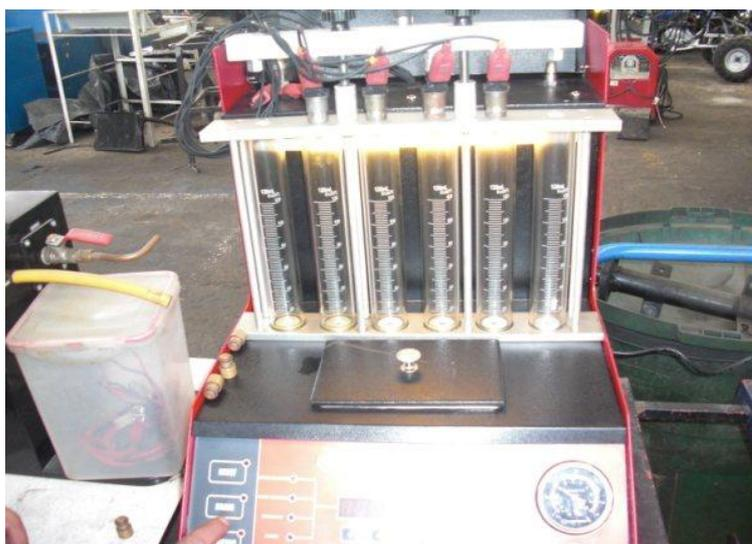
Fig. 53. Comprobación de Inyectores
