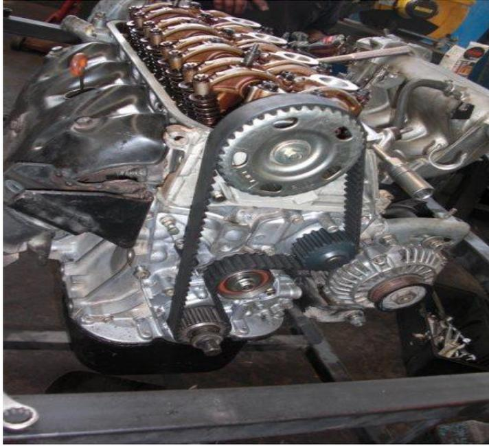
Fig. 54. Colocación banda distribución
