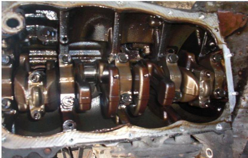
Fig. 38. Vista block motor parte inferior
