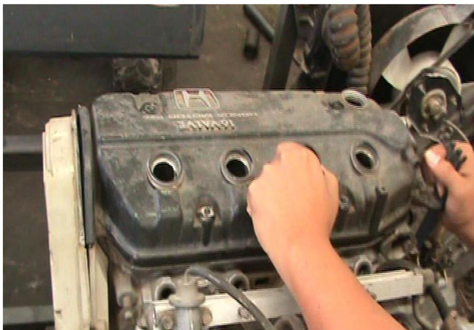
Fig. 26 Desmontaje de Tapa válvulas
