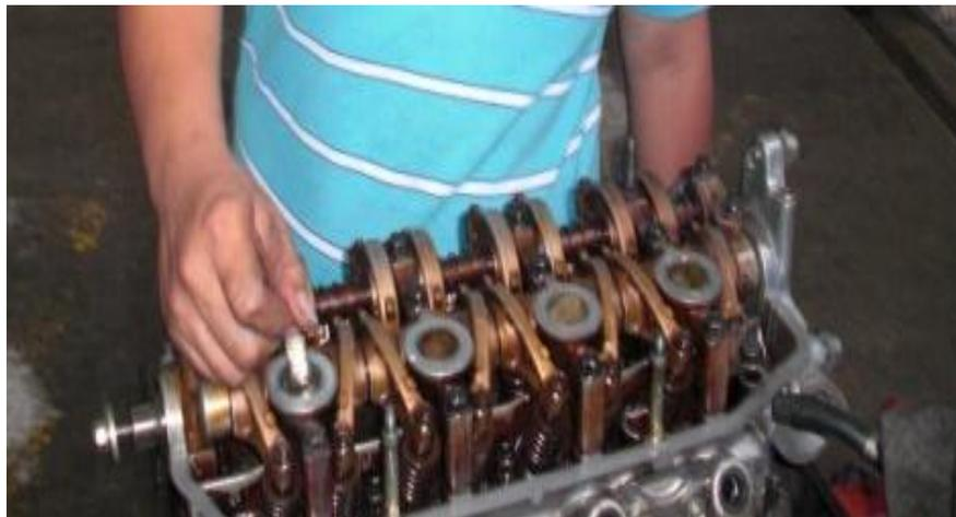
Fig. 51 Colocación de bujías
