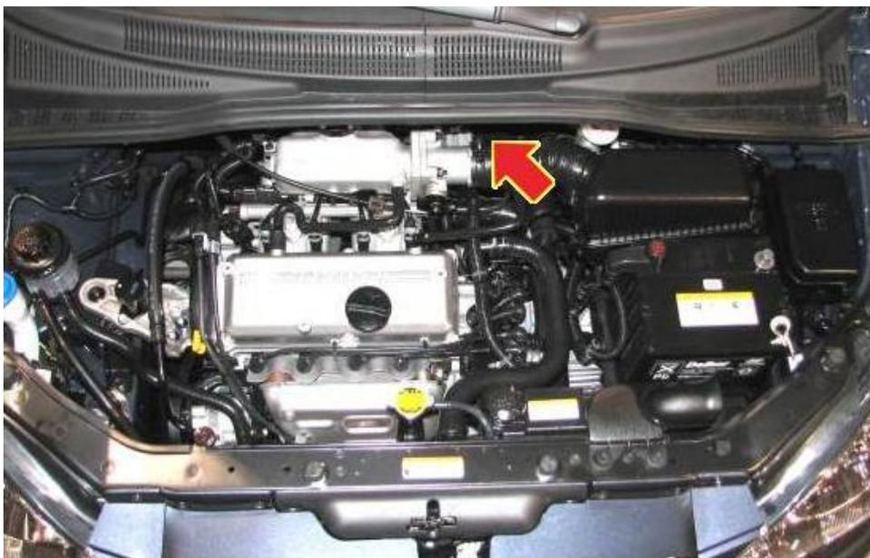
Fig.7. Localización del sensor VAF en el vehículo<sup>7</sup>
