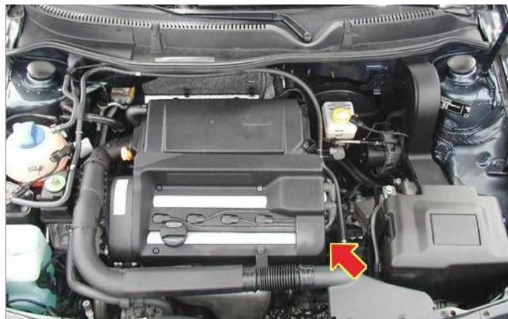
Fig. 15. Localización del Sensor de Temperatura del Refrigerante<sup>15</sup>
