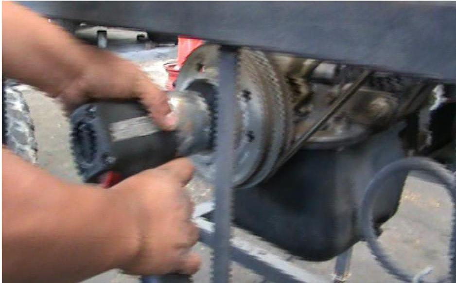
Fig. 30 Desmontaje de polea de cigüeñal
