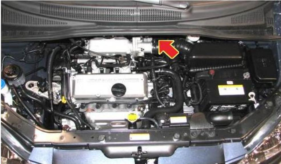
Fig.9. Localización del sensor MAF en el vehículo<sup>9</sup>
