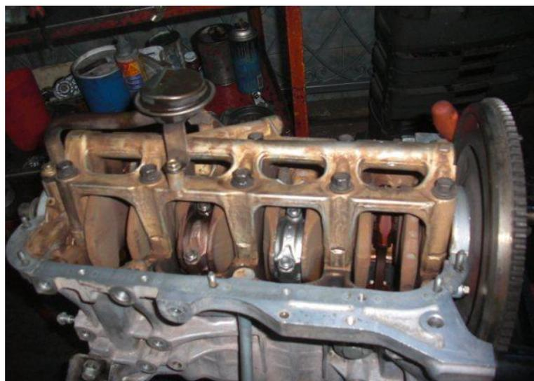
Fig.40 Vista biela cambiada
