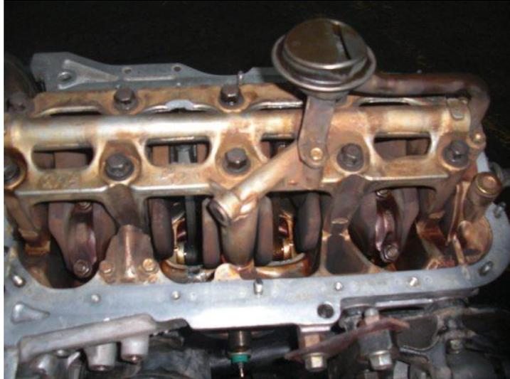
Fig. 43. Vista motor armado bancadas y bielas
